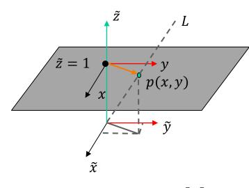
$$p \equiv \begin{bmatrix} x \\ y \\ z \\ 1 \end{bmatrix} \equiv \begin{bmatrix} wx \\ \widetilde{w}y \\ \widetilde{w}z \\ \widetilde{w} \end{bmatrix} \equiv \begin{bmatrix} \widetilde{x} \\ \widetilde{y} \\ \widetilde{z} \\ \widetilde{w} \end{bmatrix} = \widetilde{p}$$
