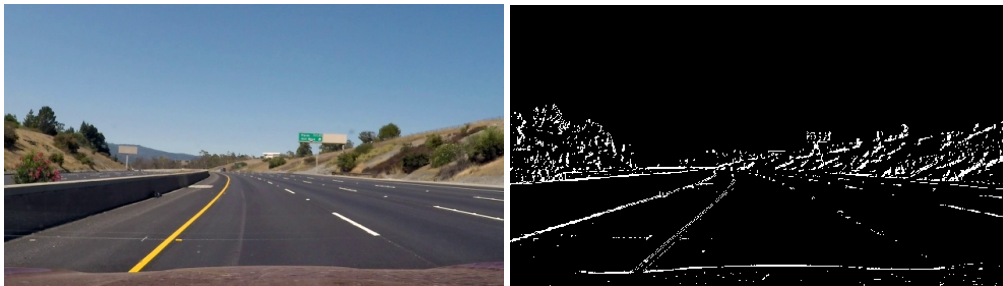
Figure 4: Image gradient. Left : Original image. Right : Gradient image.
