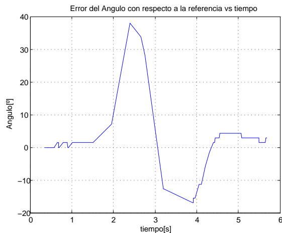
Figura 7: Evolución del error para el ángulo de orientación del vehículo (grados) vs tiempo (segundos), en presencia de perturbaciones, (en la salida).
